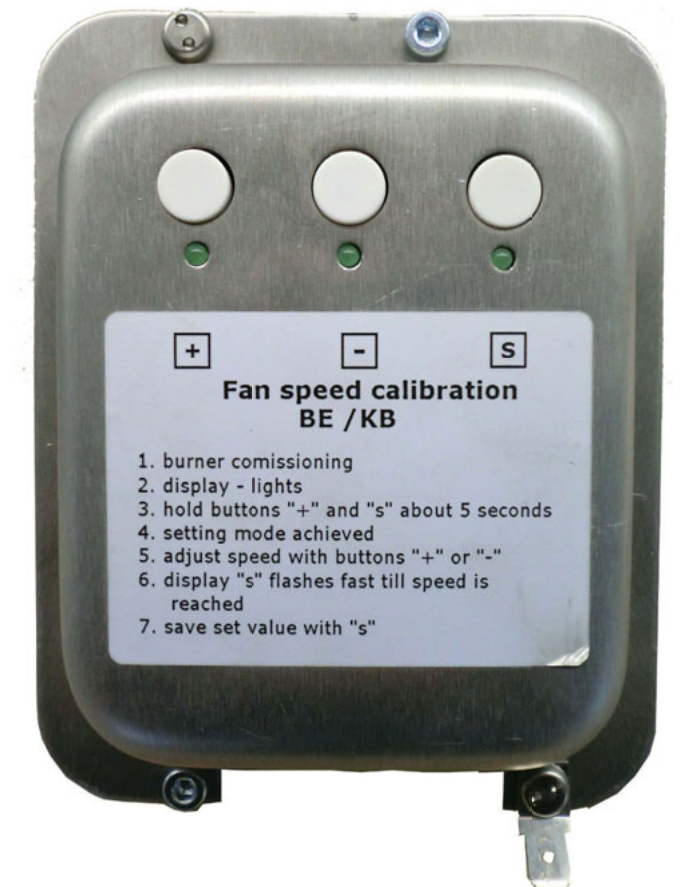
Regelplatine mit Beschreibung der Gebläsedrehzahleinstellung
